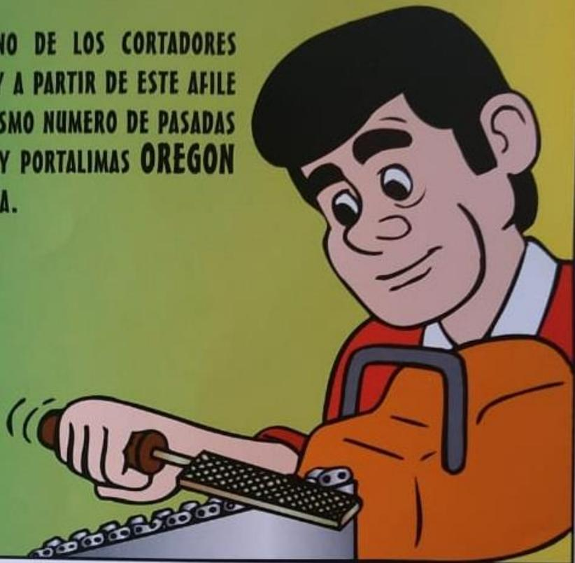
¡LA LUBRICACION DE LA CADENA Y LA BARRA SON VITALES! TRABAJE SIEMPRE CON ACEITE DE BUENA CALIDAD Y LIMPIO. NO UTILICE ACEITE QUEMADO, YA QUE ADEMÁS DE NO LUBRICAR, DESTRUYE EL SISTEMA DE CORTE DEBIDO A LOS CRISTALES DE CARBONO.
