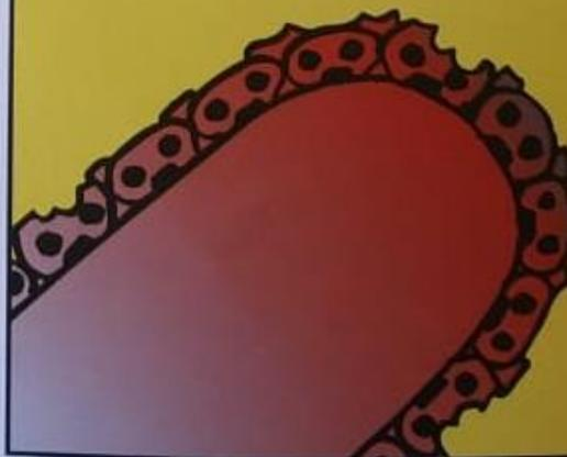
PARA CADA TIPO DE DIENTE EXISTEN ESPECIFICACIONES PROPIAS DE AFILADO Y CALIBRAJE. PARA NO EQUIVOCARSE Y PARA OBTENER EL MAXIMO RENDIMIENTO DEL DIENTE DE SUS CADENAS OREGON, USEN EL PORTALIMAS Y EL CALIBRADOR OREGON ADECUADOS.
