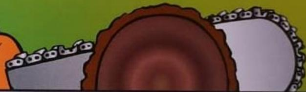
CUANDO LA CADENA ES NUEVA, LA ALTURA DEL TALON YA VIENE AJUSTADA DE FABRICA Y NO DEBE SER ALTERADA. A MEDIDA QUE USTED VA AFILANDO LA CADENA, EL DIENTE SE VA ACORTANDO Y POR SER INCLINADO HACIA ATRAS, LLEGA EL MOMENTO EN QUE EL DIENTE Y EL TALON VAN QUEDANDO A LA MISMA ALTURA.
